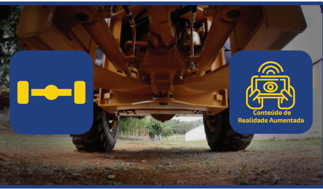
Video 4: Chassi articulado e eixo traseiro oscilante
